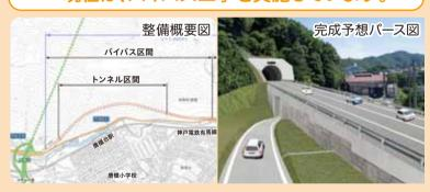
唐櫃大橋交差点から約1kmはトンネルを含むバイパスの整 備をします。バイパス工事が完成すると大雨による通行規 制がなくなり、災害発生時でも幹線道路としての機能を十 分に発揮することが期待されます。
