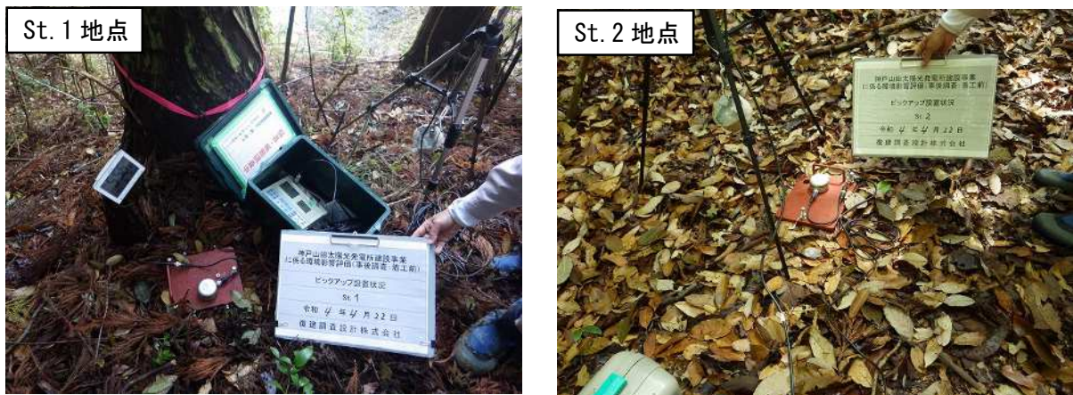
写真 3.3-1 調査の実施状況（建設作業振動）
