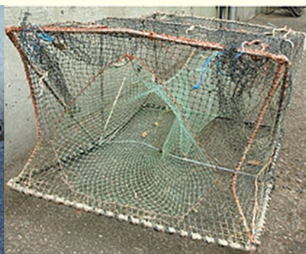
写真3 ↓アカミミガメ防除に用いたわな 特注の定置網
