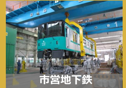
ガントリークレーン
