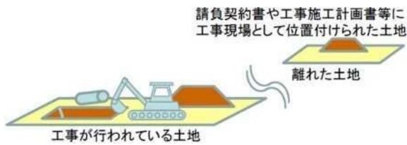
図 1-11 「工事の現場」の考え方
