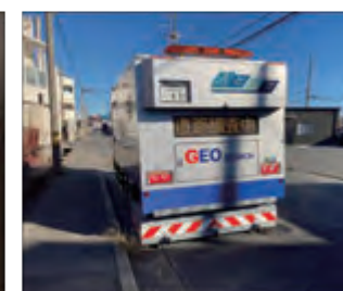
空洞探査車による調査
